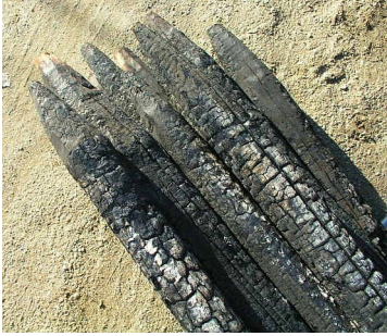
Kuivana hiillettyjä marjapensaan seipäitä – hiiltäminen on ulottunut osin vähän liian syvälle puuhun.
