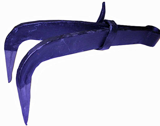
Sepän takoma seinävara . Tämä malli on jännitetty eli siinä ei tarvita keskelle puupalikkaa kärkien säätöä varten. Vara voitiin kiinnittää säätörenkaan piikistä hirteen odottamaan seuraavaa varausta.
