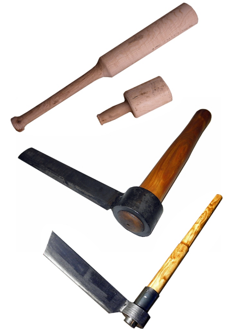
Sorvatut pihlajanuijat ja hitsattu pieni ja iso liistekirves . Isompaa nuijaa voi lyhentää lyöntipäästä, jos se tuntuu liian raskaalta yhden käden käyttöön. Yksinkertaisesti nuijan valmistaa veistämällä/vuolemalla pyöreästä, kuivasta puusta – nuijat ovat kulutustavaraa.
